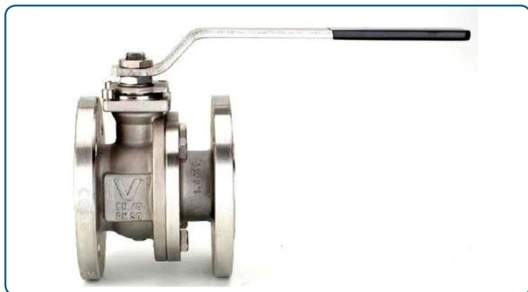
Полнопроходной шаровой кран, углеродистая сталь, пожаробезопасный, антистатическое исполнение по классификации ATEX Ex II 2G/D с T6
