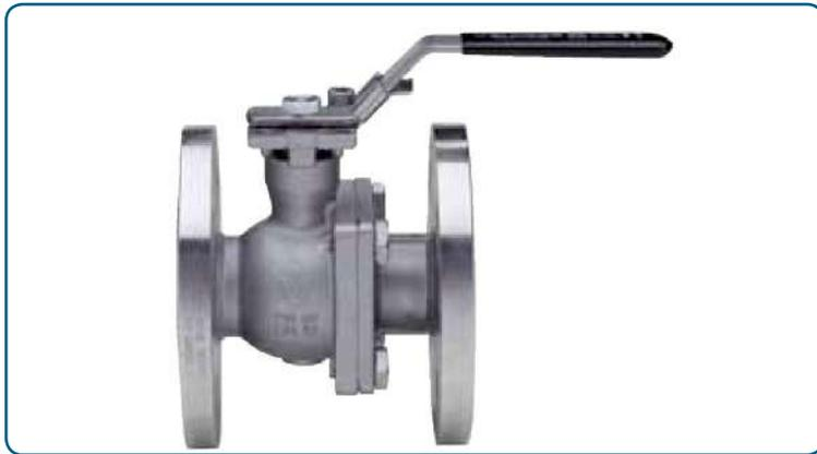
Полнопроходной шаровой кран, нержавеющая сталь, пожаробезопасный, антистатическое исполнение, межфланцевое расстояние по EN558 basic series 27
